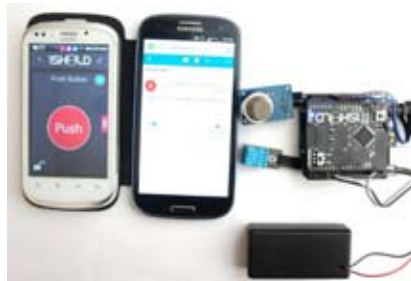
Рисунок 1. Внешний вид прототипа устройства и результаты его работы (устройство взаимодействует с телефоном белого цвета и при нажатии на красную кнопку отправляет данные по e-mail на телефон черного цвета).
